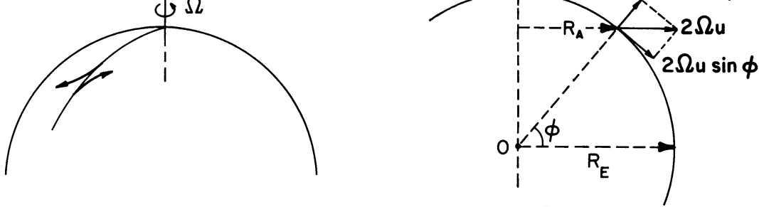
Fig.3: Corioliskraft 2\Omega u , die mit einer zonalen Geschwindigkeit u einhergeht (der Wind u ist in die Blattebene hinein gerichtet). Die Kraft wird in einen horizontalen Anteil 2\Omega u \sin(\phi) und einen vertikalen Anteil 2\Omega u \cos(\phi) zerlegt. In der Atmosphärenphysik ist der horizontale Anteil bedeutend wichtiger. Man führt deshalb den Coriolisparameter f = 2\Omega \sin(\phi) ein.
